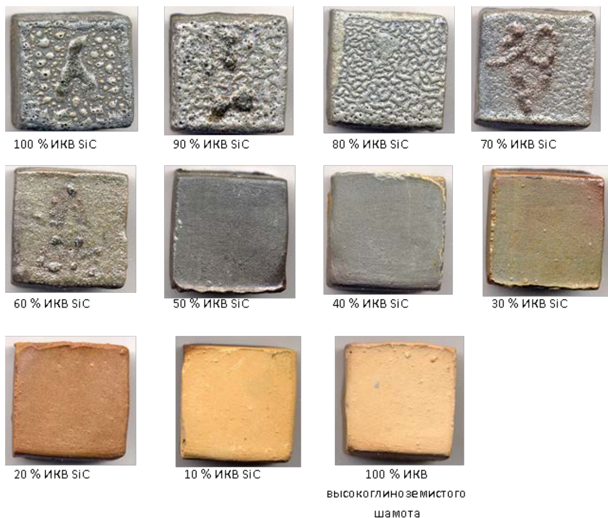
Рисунок 3.25 – Внешний вид образцов муллит-карборундового ИКВ, полученных по отдельной технологии и термообработанных при 1300 °С [193]
